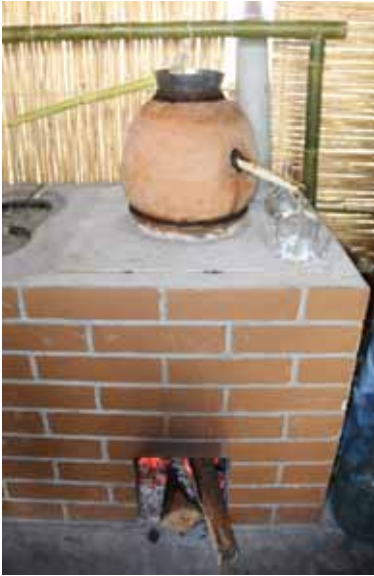
Simpelt, men effektivt destillerings-apparat til mezcal
